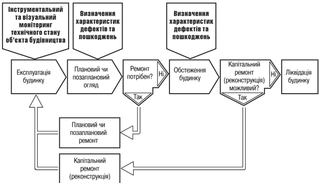
Рис. 5. Будівельно-вимірвальні роботи в період експлуатації об'єкта будівництва
