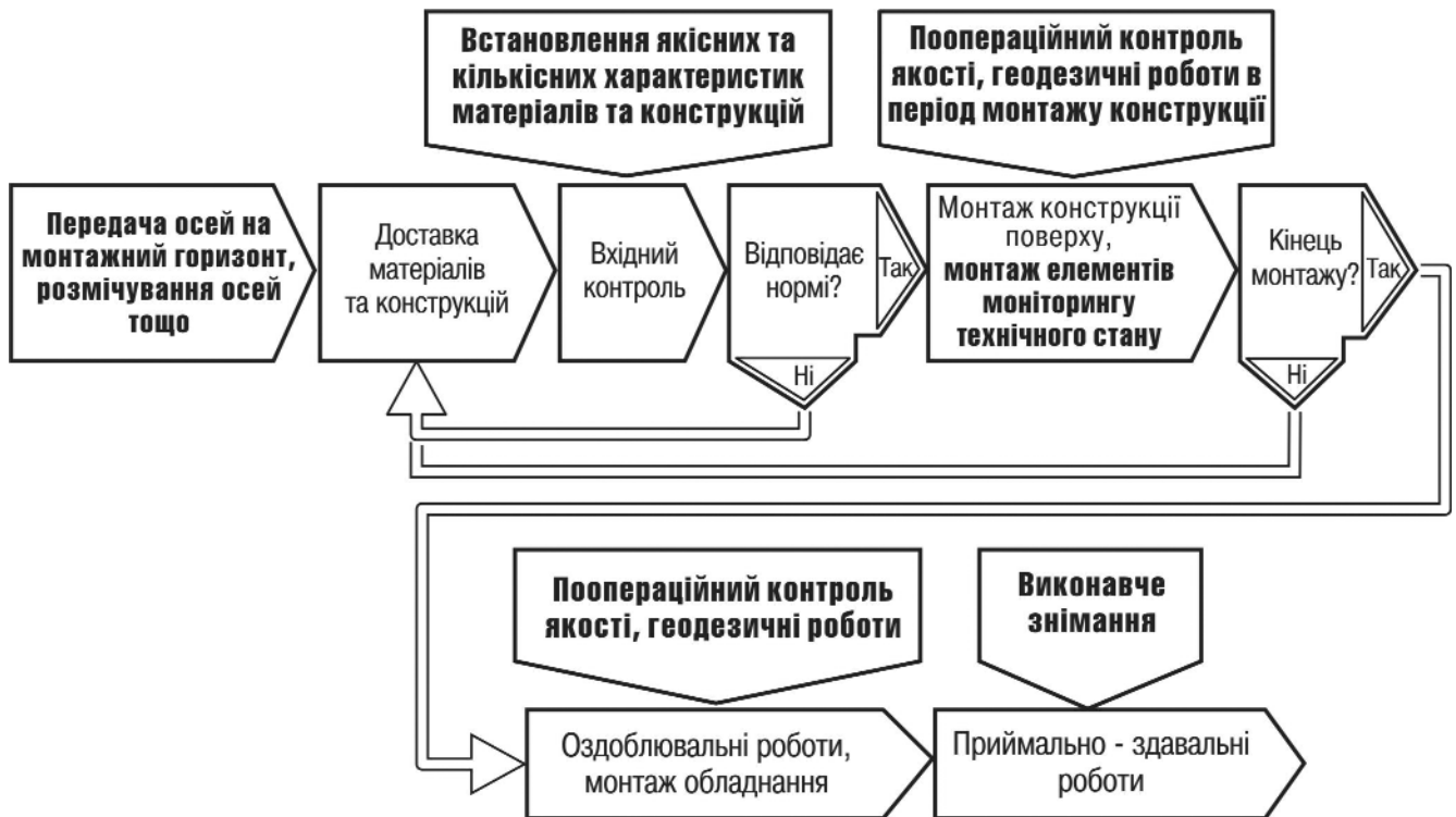
Рис. 4. Будівельно-вимірвальні роботи в період зведення об'єкта будівництва
