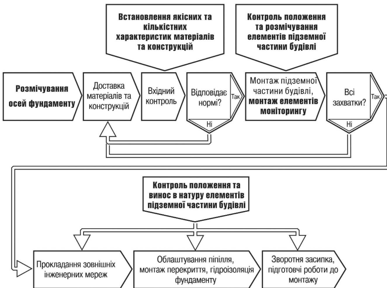
Рис. 3. Будівельно-вимірювальні роботи в період нульового циклу будівництва
